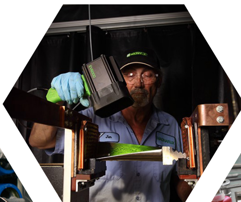
Magnétoscopie et ressuage
